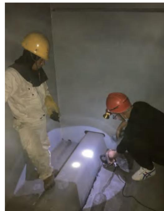
焊缝磁粉检测
